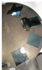
Figura 6. Imagen de sustratos de cuarzo (cuadrado) y de vidrio (rectangular) recubiertos con óxido metálico B.
