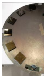
Figura 5. Imagen del recubrimiento 2 sobre acero inoxidable y PP.
