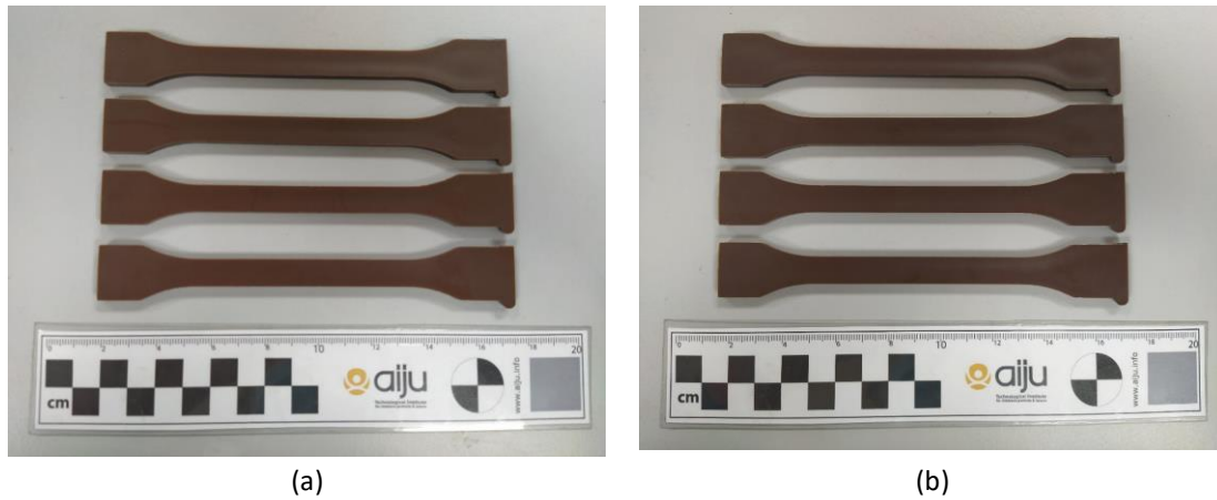
Figura 3. Probetas de PBS con lignina con diferente contenido en peso de masterbatch comercial: (a) 10 %, (b) 30 %.
