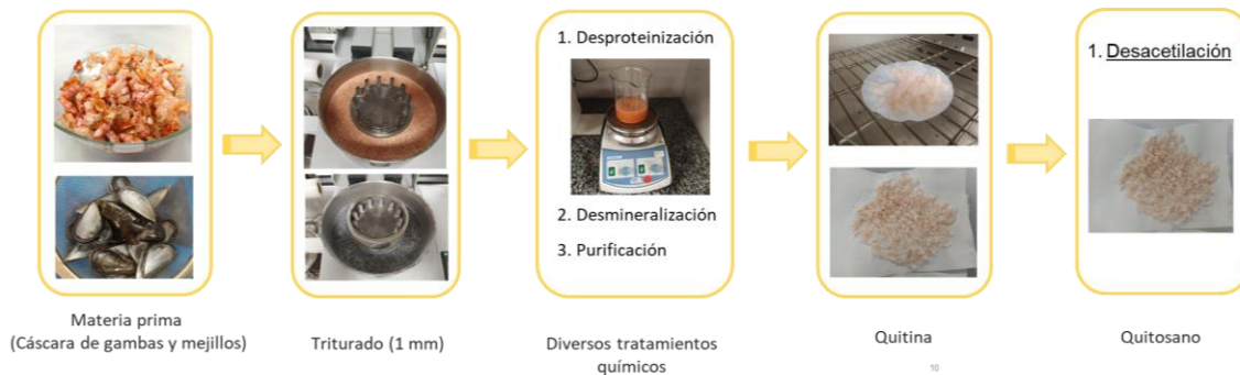
Figura 8. Esquema del proceso de extracción.
