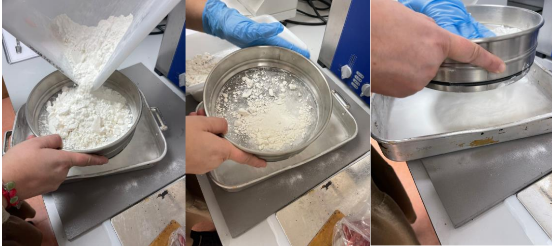
Figura 12. Proceso de mezclado y tamizado de la PA 12
