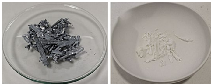
Zinc electrodepositado: a) antes de la calcinación, b) tras calcinación (900°C, 6 horas) y c) DRX del ZnO obtenido (pureza 100% aprox.).
