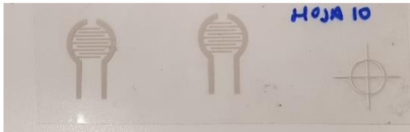
Ilustración 7.- Prototipos sensores avanzados estructura interdigitada
