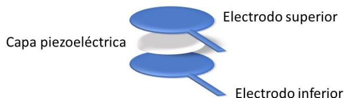
Ilustración 4.- Estructura sensor piezoeléctrico
