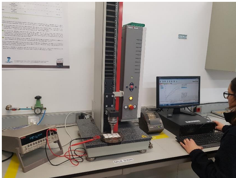
Ilustración 1.- Montaje para caracterización de sensores.
