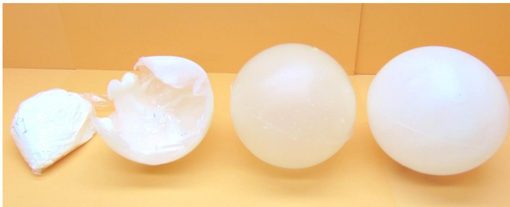
Figura 9. PVC + ADILEN200 + Estabilizante. De izquierda a derecha, 10% - 20% - 30% - 40% de ADILEN200
