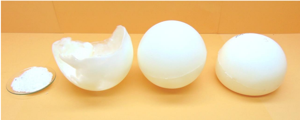
Figura 8. PVC + ESBO + Estabilizante. De izquierda a derecha, 10% - 20% - 30% - 40% de ESBO
