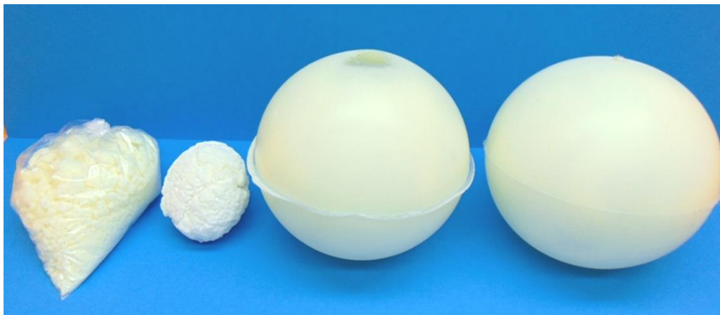
Figura 7. PVC + ELO + Estabilizante. De izquierda a derecha, 10% - 20% - 30% - 40% de ELO
