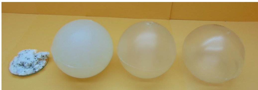
Figura 6. Piezas de PVC con diferentes porcentajes de ATBC (10, 20, 30, 40%) obtenidas empleando el molde de rotomoldeo
